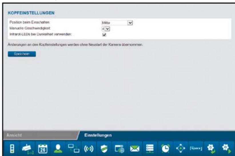
1. **Infrarot-LEDs bei Dunkelheit verwenden:** Ist diese Option aktiviert, so werden bei Dunkelheit die Infrarot-LEDs als zusätzliche Lichtquelle zugeschaltet.
